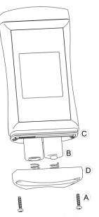
Fig. 6: Batteriewechsel
